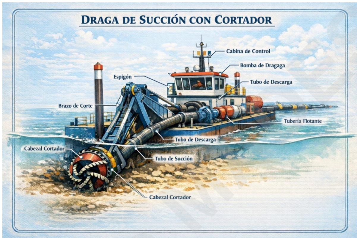
Figura 7. Diagrama de un Dragas de Succión con Cortador o CSD
