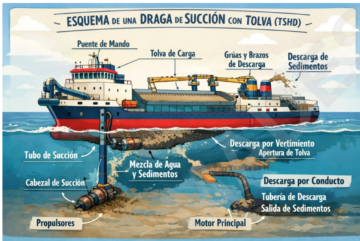
Figura 8. Esquema de una Dragas de Succión con Tolva – TSHD
