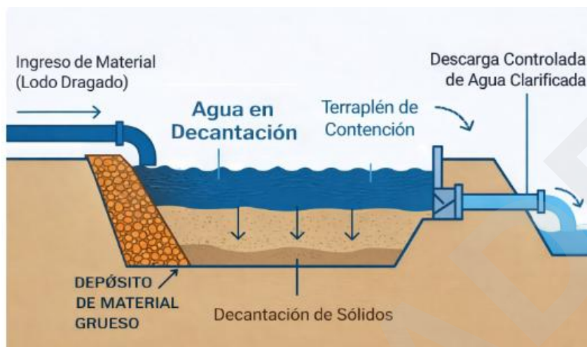
Figura 4. Diagrama de refulado o forma de relleno de los materiales de dragado
