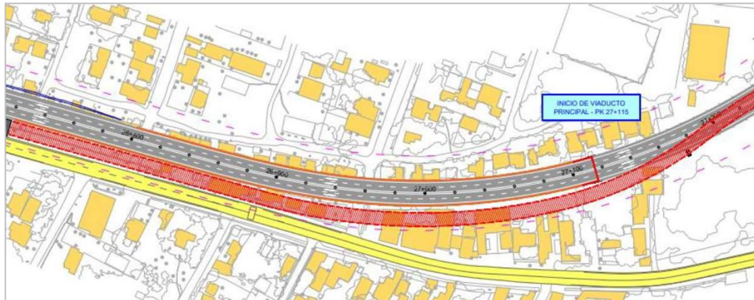
Figura N° 1. Muros de tierra armada entorno al Pk 27+000
