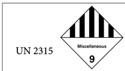
Figura 69: Etiquetado de acuerdo con la ADR para PCB líquido
