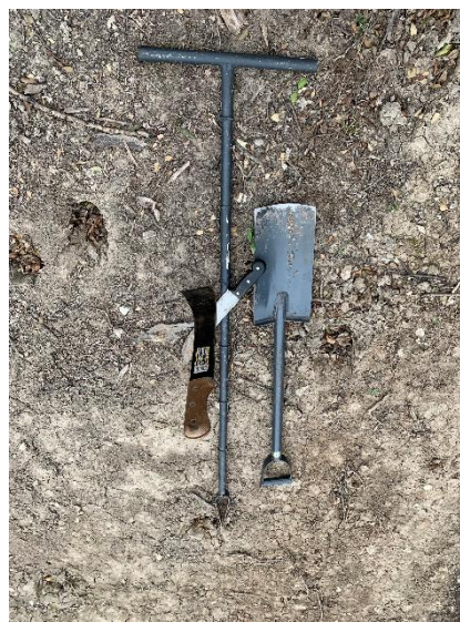
Fotografía 6 Elementos utilizados para la toma de muestras de suelo
