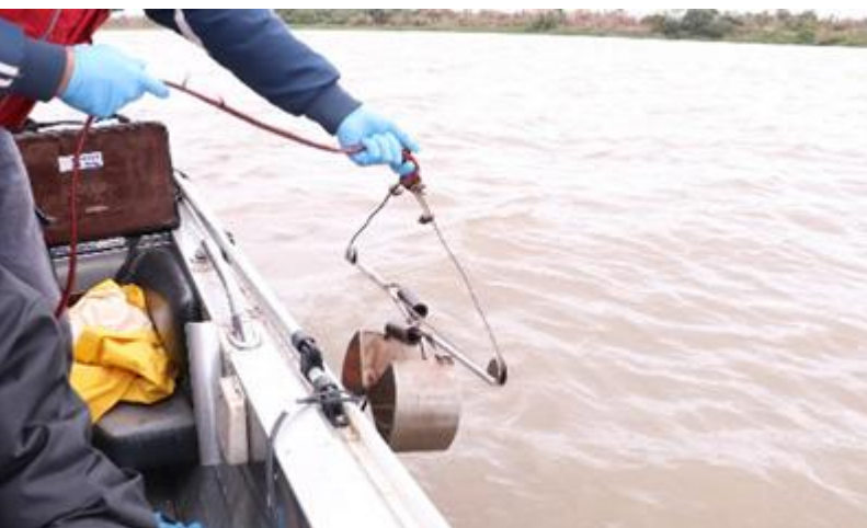
Figura 25. Uso de draga colectora Van Veen
