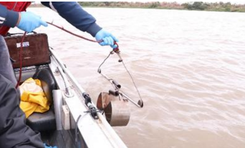
Figura 21. Uso de draga colectora Van Veen
