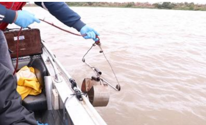
Figura 27. Uso de draga colectora Van Veen
