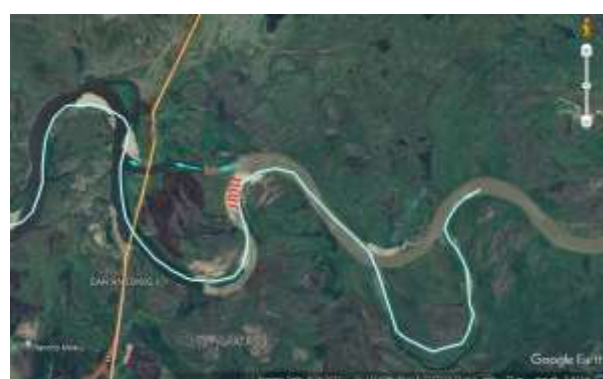
Figura 4b: Río Jejuy en el año 2023. El eje del río corresponde al año 2013. Se observan meandros abandonados y nuevos brazos. El 100% del caudal de aguas bajas del río circula por el aliviadero
