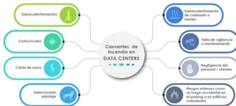
Ilustración N° 54 – Causantes de incendio en un data center
