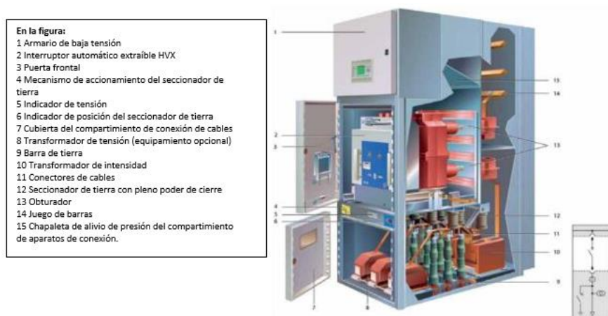
Ilustración N° 33 – Celda de 23 kV
