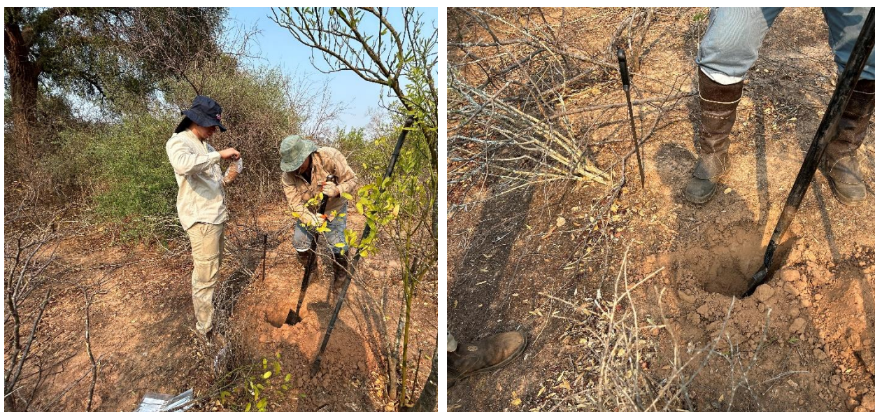
Fotografía 5 y 6 Toma de muestras de suelo con barreno
