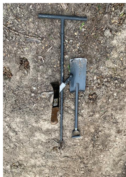
Fotografía 8 Elementos utilizados para la toma de muestras de suelo
