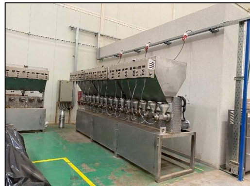
Fotografía N° 5. Prensa para extraer aceites de las semillas, asi como expeler
