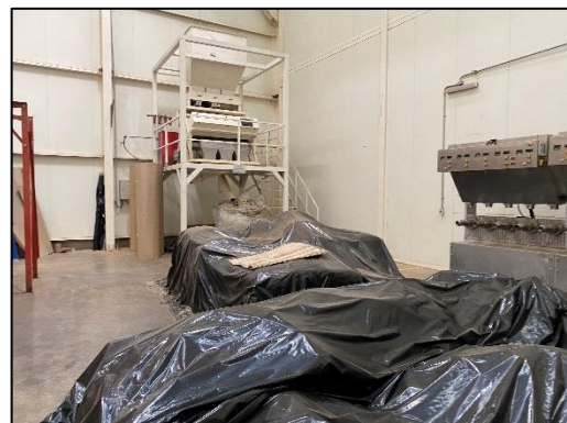
Fotografía N° 7. Maquina selectora óptica, que se usa para clasificar por colores las semillas
