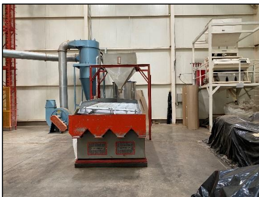
Fotografía N° 6. Mesa Densimétrica para realizar limpieza y selección de semillas por peso
