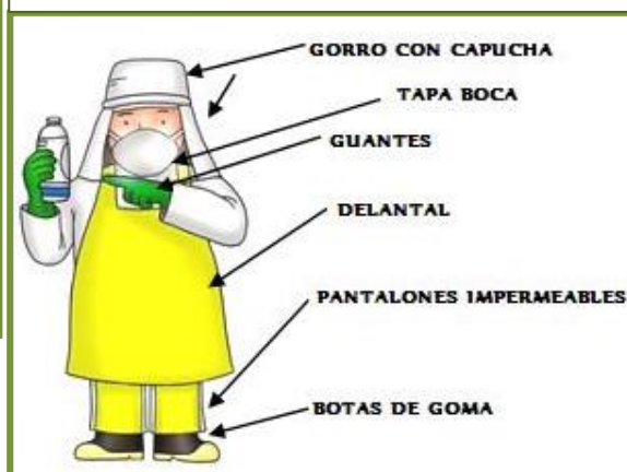
Figura N° 2: Equipos de protección individual para la realización del triple lavado de los envases de agroquímicos
