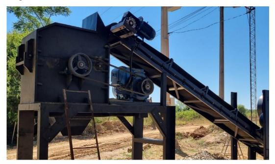
Posteriormente es trasladada por medio de una cinta trasportadora provista con un motor de la marca weg de 4hp de potencia al molino de martillo con una capacidad de producción de 10 toneladas por hora. Donde ocurre la trituración final.
