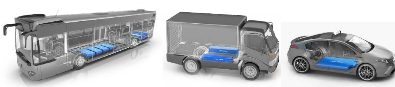
Figura 25. Ubicación preferente de los paquetes de baterías en los VE
