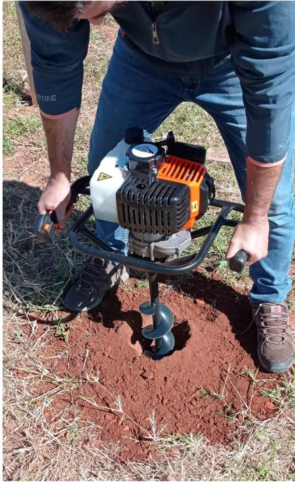
Figura N° 5: Muestreo con barreno
