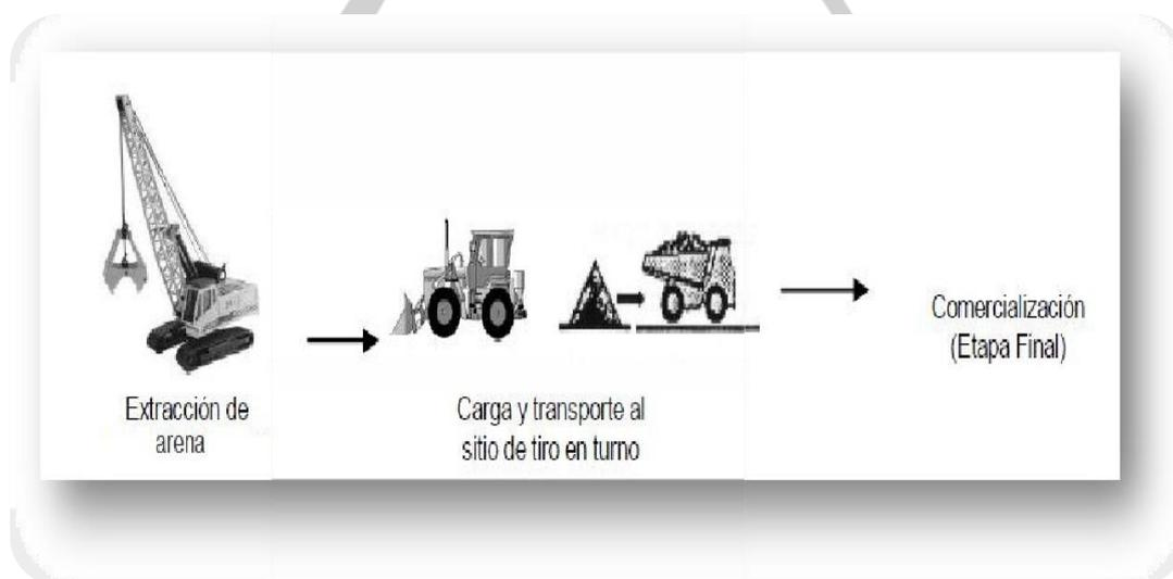
**Extracción:** El proceso de extracción se llevará a cabo de la siguiente manera: la draga ingresa al cauce del río (faja de 10 metros de anchura contigua al cauce de las corrientes (ríos, arroyos) a partir del nivel de aguas máximas ordinarias. Esta faja será de 5 metros cuando los cauces tengan una anchura no mayor a 5 metro) y luego se desplaza sobre el playón natural
