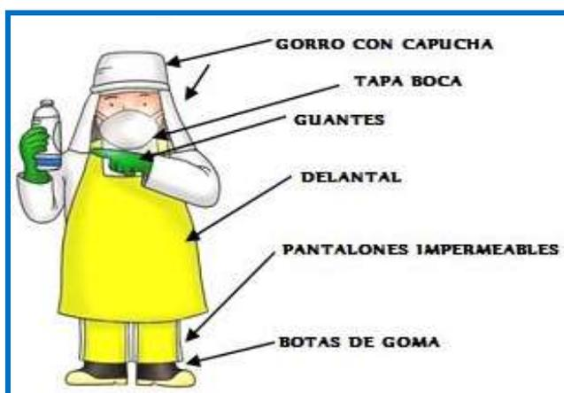
Figura N° 2: Equipos de protección individual para la realización del triple lavado de los envases de agroquímicos.
