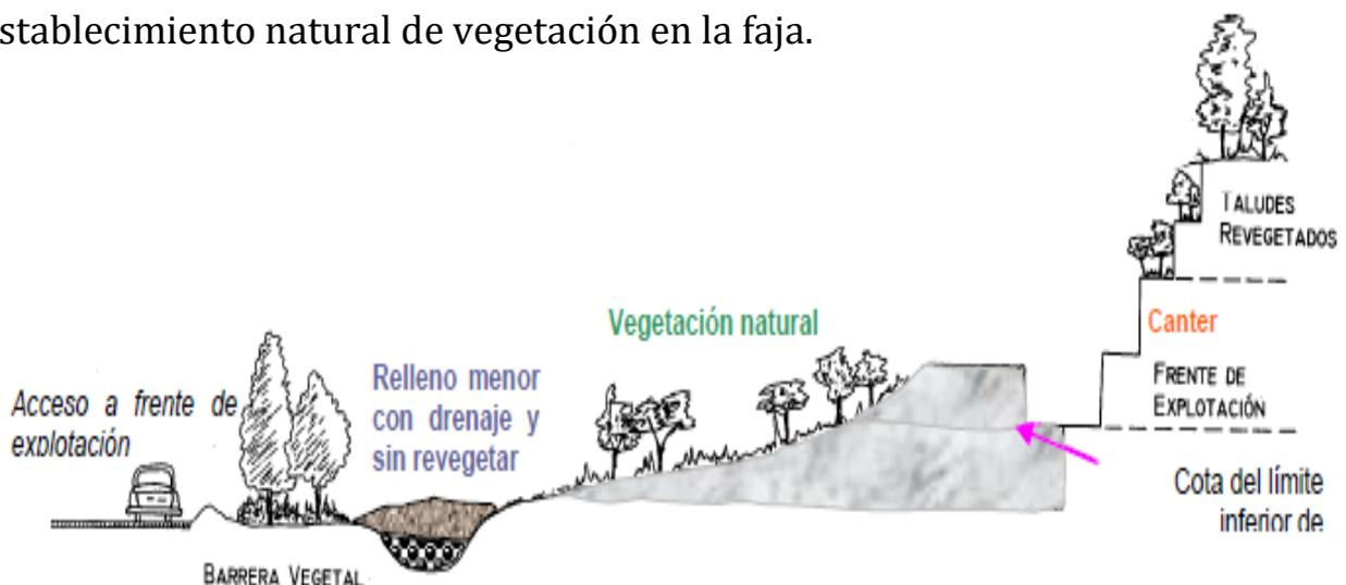
**Figura 4.15.** Esquema general ilustrativo de algunos elementos de recuperación-conservación del impacto al paisaje y restauración de los frentes de explotación. Modificado de J. Romero, 1998.
