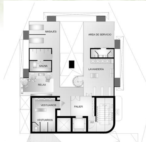
Figura N° 8: Vista en planta del Spa y Área de Servicio. Fuente: El proponente (2.016).
